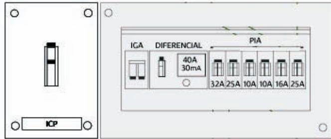
ICP: Interruptor de Control de Potencia
