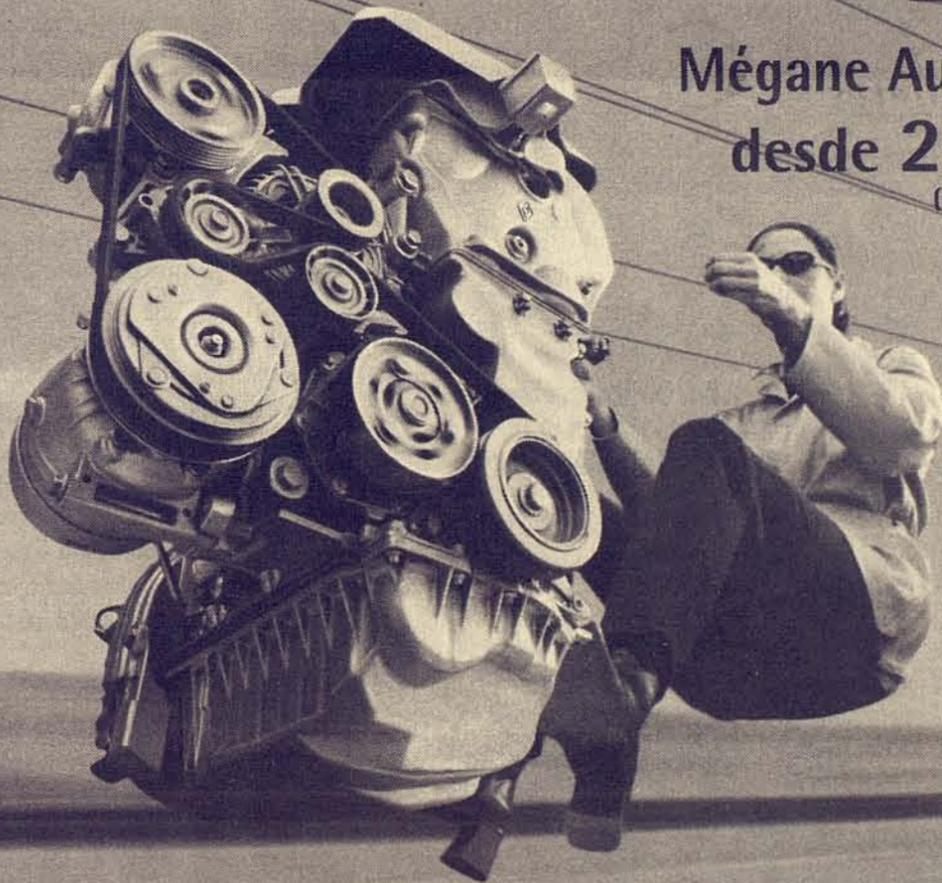
Motor Diesel 1.9D. Control Electrónico Programado de la Inyección (EPIC) • Sistema electrónico de arranque en frío • Suspensión pendular motor/chasis (filtro de vibraciones) • Menor consumo: 4,8 l/100 km (consumo normas CEE N° 93/116 ciclo extraurbano). Equipamiento. • 4 Airbags inteligentes • ABS • Sistema de Asistencia a la Frenada de Emergencia • Cinturones de Sujeción Programada. PARA MÁS INFORMACIÓN, LLAME AL 902 333 500. [www.renault.es](http://www.renault.es)
