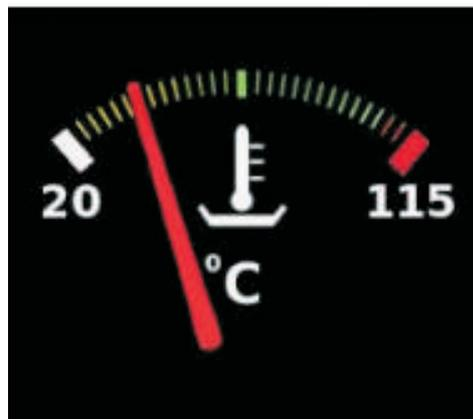
correcta, o que tarda demasiado tiempo en alcanzar esa temperatura, es probable que tenga un termostato defectuoso en el sistema del radiador.
